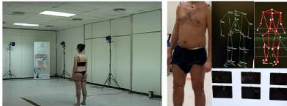
Figure 2: Sistema di gait analisi della Fondazione Santa Lucia, realizzato dalla BSMART, e riconoscimento dei marker attraverso la AI.
